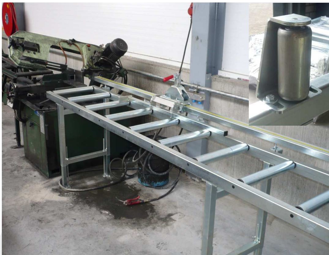
Rollenbanen type L met verzinkte stalen rollen ø51x2. Rollengte 400mm. Hoogte 630mm t/m 930mm of 850mm t/m 1150mm.
